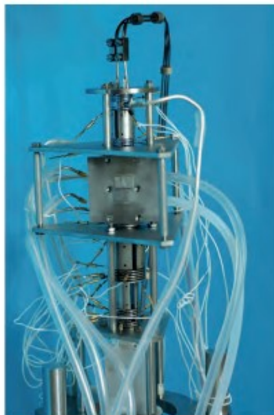
Obr. – Trochoidální elektronový spektrometr, který slouží k výzkumu nízkoenergetických elektronových srážek
